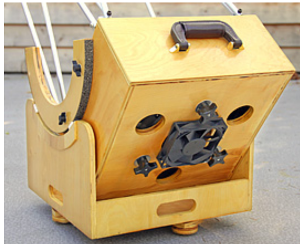
Figura 12 – Instalação do ventilador no fundo do espelho primário (SERONIK, 2010)
