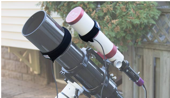
Figura 77 – Exemplo de Dew Band encontrada no mercado ( Astrobackyard, 2020 )
